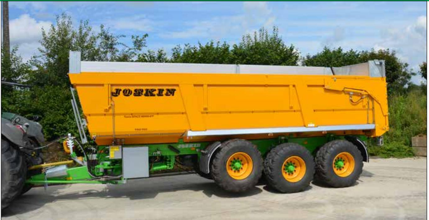
JOSKIN bietet ab sofort für die landwirtschaftlichen Muldenkipper Trans-SPACE 7000/125 und 8000/150 komfortable, hydraulische verstellbare Bordwanderhöhen an. Diese erlauben ein leichteres Beladen bei gleichzeitig erhöhtem Transportvolumen. Das Transportvolumen steigt beim Modell 7000/125 um 8,4 m<sup>3</sup> und beim Modell 8000/150 um 9,4 m<sup>3</sup>.
